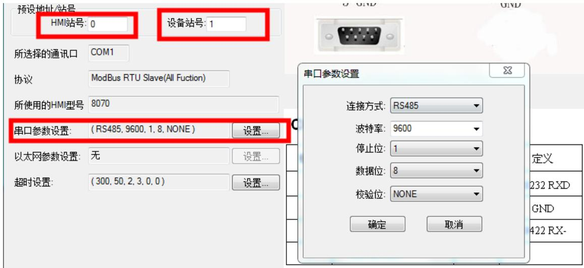
串口参数要用所连接的 modbus 设备完全一致，否则不能通讯：
